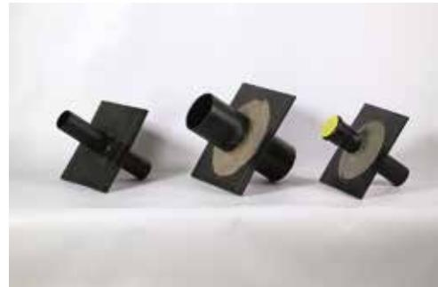
Unsere Bodenplatten- und Mauerdurchführung aus PE-Material mit mittig aufgeschweisstem Dichtflansch, Längen 300 mm, mit stumpfen Rohrenden.
